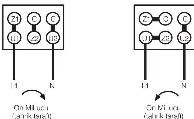
Kalkış+Daimi kondansatörlü motorlarda, elektronik kalkış rölesinin 6 ve 9 no.lu klemens bağlantıları (ana sargı uçları) değiştirilerek motor dönüş yönü değiştirilir.
